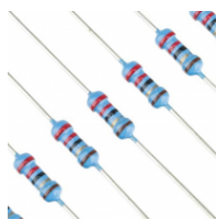
RE362F RESISTENCIA METALFILM 0.4W 1% 3K6
