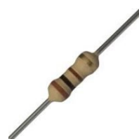
RE223 RESISTENCIA CARBON 22K 1/4W 5%
