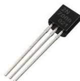
2N7000 MOSFET 60V 0.2A 5 OHM 0.4W
