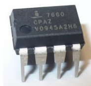
ICL7660CPA CONVERSOR DE TENSION +5V A -5V DIP-8
