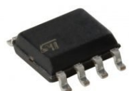
L78L05CD REGULADOR LINEAL 5V 100MA SO-8
