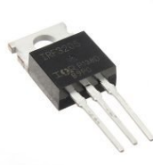
IRF3205 MOSFET N 110A 55V 0.008 OHM TO-220
