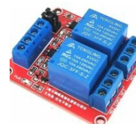
RELE2CH5V MODULO RELE 2CH 5V OPTOACOPLADO
