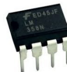
LM358 DOBLE AMPLIFICADOR OPERACIONAL
